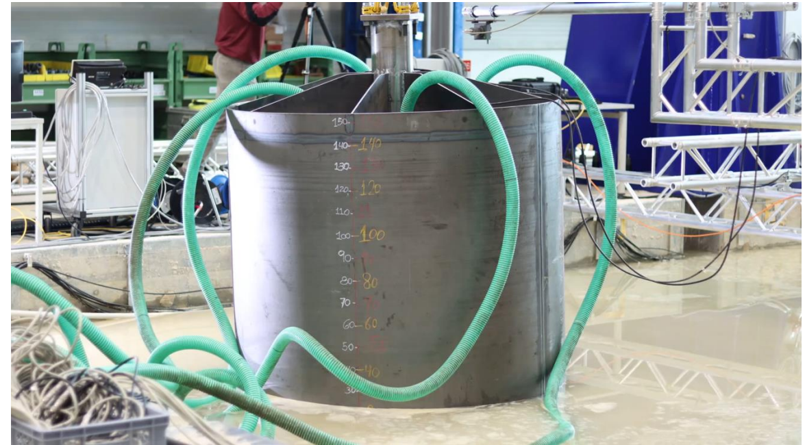
Probeinstallation eines Modellbuckets (D1600 mm und L1420 mm) im Februar 2022
