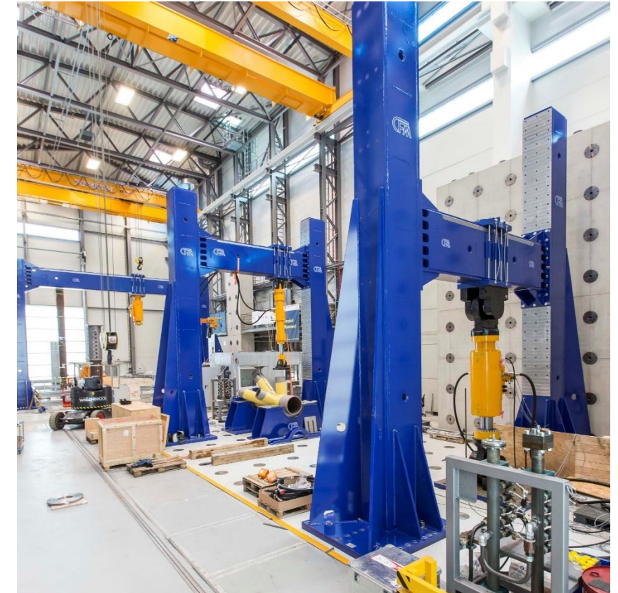
3D-Spannfeld – Flexibel, schnell und sicher aufspannen
