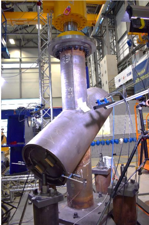
Schwingversuch Sinusförmige, konstante Belastung im Zugschwellbereich mit f = 1,5 \text{ Hz}
